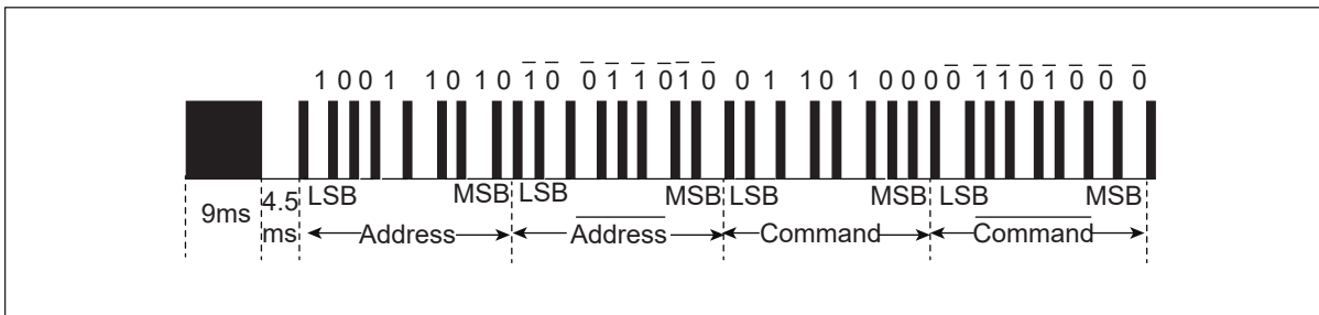
图 14.2: NEC 协议波形
